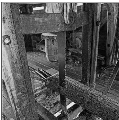
Slik oppgangssag ble nyttet på 1700-tallet. Skar de bord, var det flere sagblad ved siden av hverandre. Foto: Midt Troms Museum
